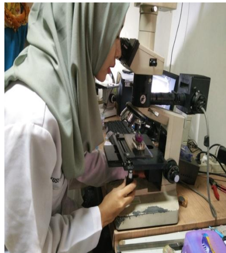
Gambar 16. Pengukuran kebocoran tepi
