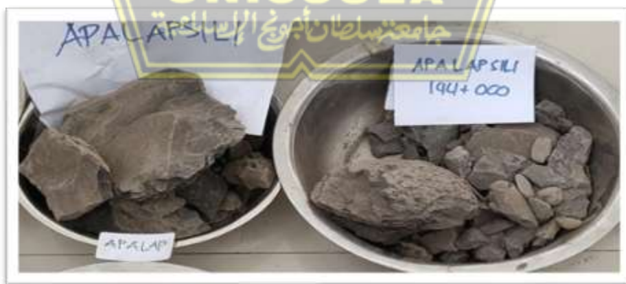
Gambar 2.4. Material Aluvial Gravel Sand (Kinang Jingkion) Dari Apalapsili, Distrik Elelim, Kab. Yalimo (Sumber: dokumentasi pribadi)
