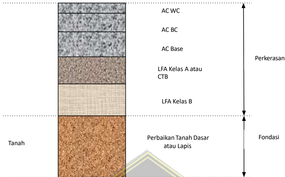
Gambar 2.1. Struktur Perkerasan Lentur Sumber: (Direktorat Jenderal Bina Marga 2017)
