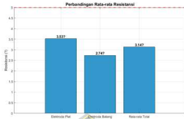
Gambar 4. 8 Perbandingan Nilai Rata-rata Resistansi Grounding Elektroda Plat dan Batang.
