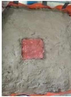
Gambar 4. 20 Tanah warna di bawah model pondasi
