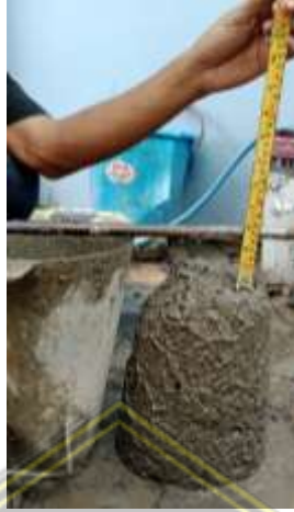
Gambar 4.15 Uji slump dengan Fly Ash 15% (Sumber : penulis)
