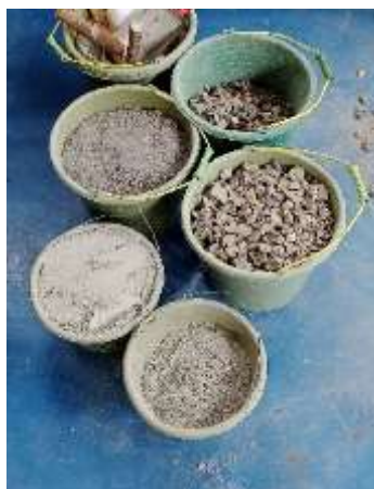
Gambar 4.3 Material yang Telah Ditimbang Sesuai Kebutuhan per 1 m 3 Beton (Sumber : penulis)
