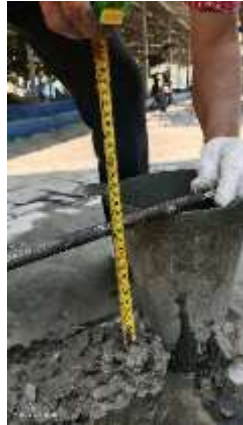
Gambar 4.12 Uji slump dengan Fly Ash 0% (Sumber : penulis)
