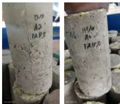
Gambar 4.20 Hasil Uji Kuat Beton FA 10% dan FA 15% (Sumber : penulis)
