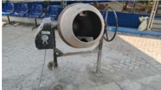
Gambar 4.4 Concrete Mixer yang Digunakan dalam Proses Pencampuran Beton (Sumber : penulis)
