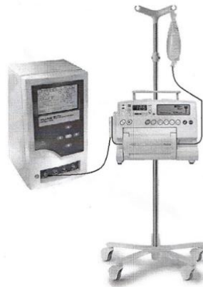
Gambar 2. 5 Setting Infusion Set dan Infusion pump dengan Infusion Device Analyzer
