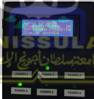
Gambar 4.16 Tampilan LCD pada Kondisi Waspada (2 Pompa Aktif)
