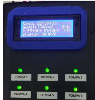
Gambar 4.20 Tampilan LCD pada Kondisi Bahaya (6 Pompa Aktif)
