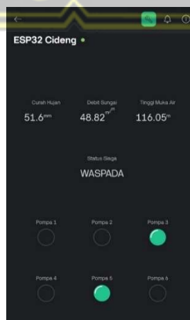
Gambar 4.23 Tampilan Aplikasi Blynk pada Hari Jumat (Pompa 3 dan Pompa 5 ON)
