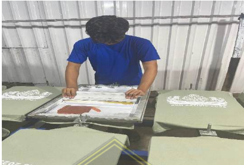
Gambar 4.9 Proses penggesutan menggunakan screening cetakan dan rakel
