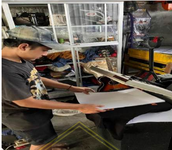
Gambar 4.11 proses pengepresan sablon
