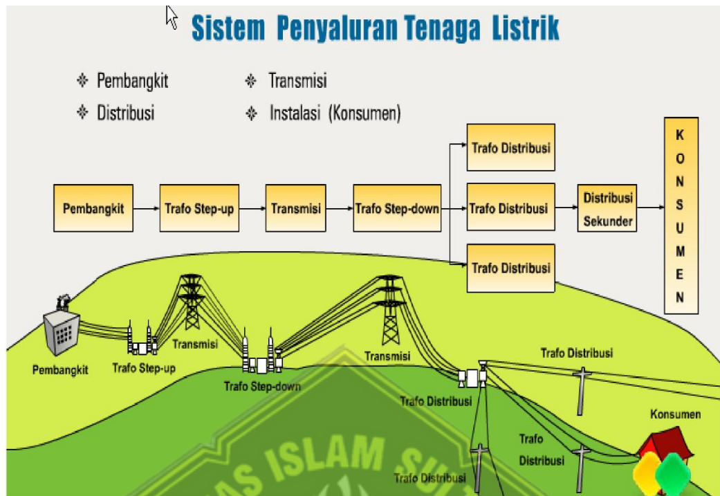
Gambar 2.1 Sistem Penyaluran Tenaga Listrik
