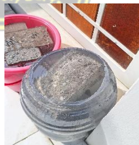
Gambar 4. 3 Perawatan benda uji
