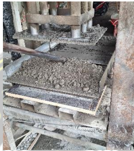
b. pencetakan dengan alat press
