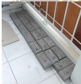
Gambar 4. 3 Perawatan benda uji
