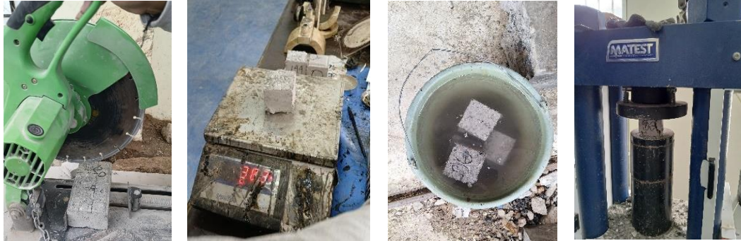
a. Pemotongan b. penimbangan c. Perendaman d. Pengujian
