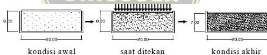
Gambar 2.2 Prinsip Kerja Metode Press Hydraulic
