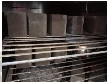
Gambar 3.17 Proses Pengeringan Paving Block Menggunakan Oven
