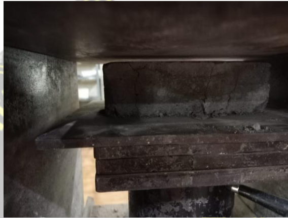
Gambar 3.16 Paving Block Setelah Melalui Uji Kuat Tekan Dengan CTM
