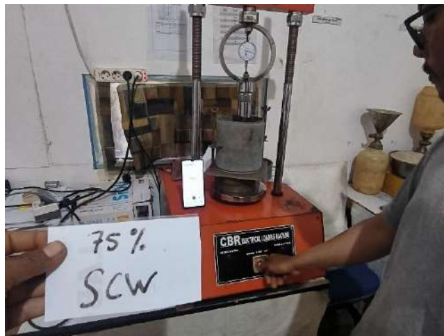
Gambar 8. Proses Pengujian CBR
