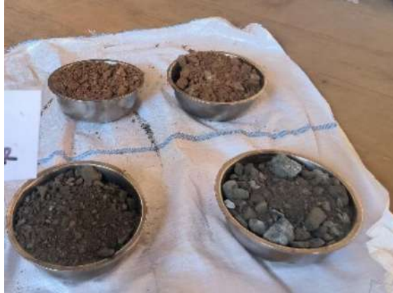
Gambar 1. Takaan Komposisi Sampel Stone Crusher Waste + Tanah Asli
