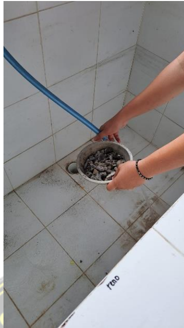
Gambar 4. 6 Kadar Lumpur Agregat Halus Cara Pencucian (Sumber: Dokumentasi Penulis, 2025)
