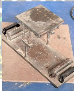
Gambar 3. 16 Alat Uji Kuat Tarik Lentur
