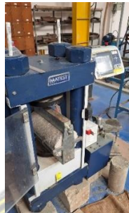
Gambar 3. 15 Alat Uji Kuat Tarik Belah
