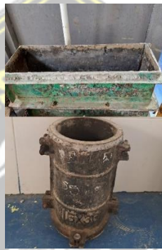
Gambar 3. 10 Cetakan Silinder dan Balok (Sumber: Dokumentasi Penulis, 2025)
