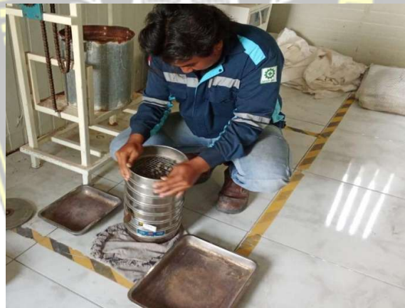
Gambar 4.9. Pengujian Gradasi Agregat Pasir Beton Ex. Klaten
