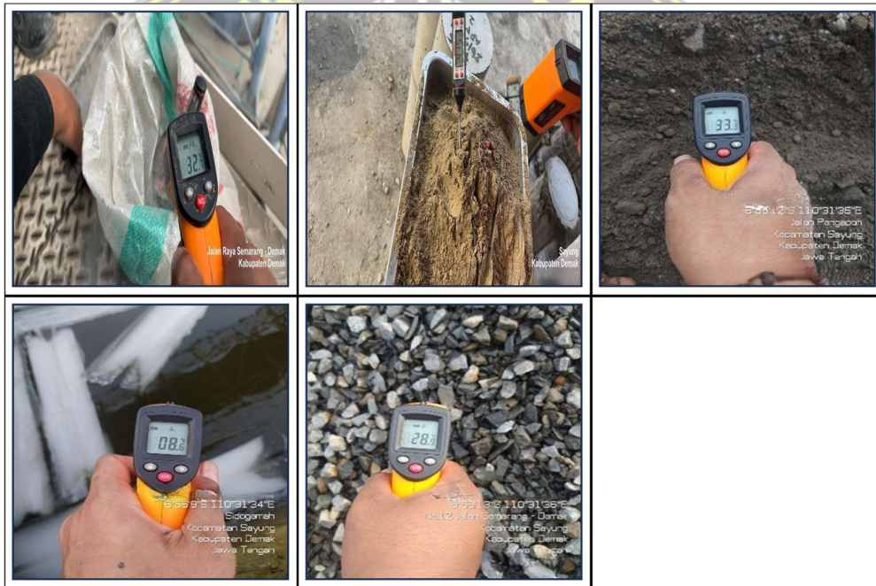
Gambar 4.41. Pengecekan Suhu Material Sebelum Pencampuran Beton Mass Concrete
