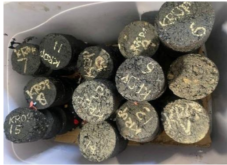
Gambar 4. 10. Benda Uji Variasi Kain Polyester dan Resin Polyester
