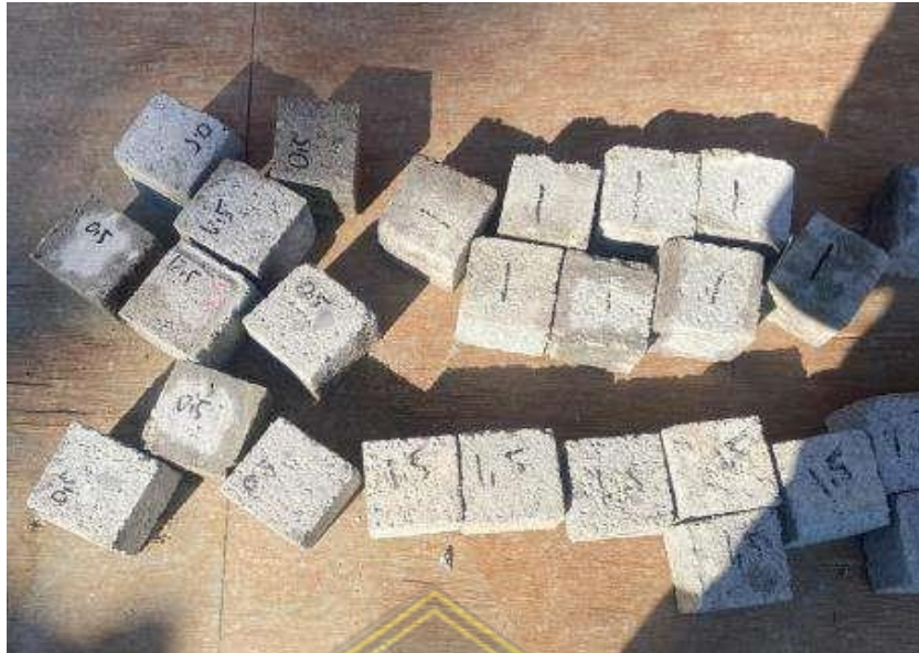
Gambar 4. 4 Paving Block yang telah dipotong
