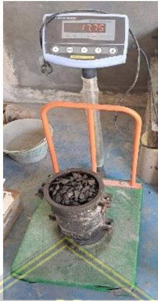
Gambar 4. 3 Berat Volume Agregat Kasar (Pasir Muntilan)
