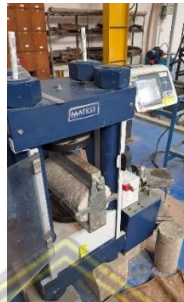
Gambar 3. 15 Alat Uji Kuat Tarik Belah
