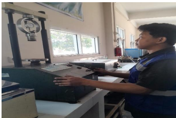
Gambar 4.5 Pengujian Marshall Test
