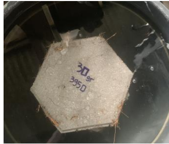
Gambar 4. 3 Uji daya serap air
