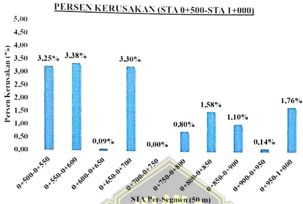
Gambar 4.22. Persentase Kerusakan Jalan (STA 0+500 – STA 1+000)
