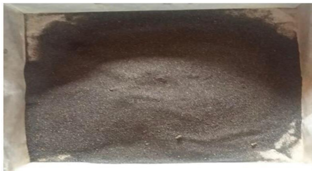
Gambar 4.2 Persiapan bahan Pasir laut sebagai bahan tambah Sumber: Dokumentasi Pribadi
