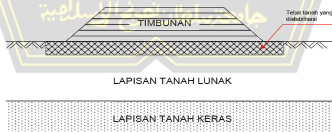
Gambar 2.2 Stabilisasi Pada Tanah Lunak (Dept. PU. 2005)
