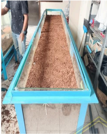
Gambar 4.27. Kondisi Awal Tanah Tidak Jenuh
