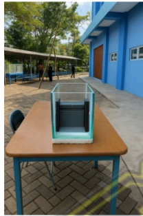
Gambar 3. 18. Perakitan Dudukan dan Tanggul Apung Skala Lab Ke Dalam Bak Uji
