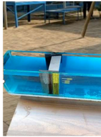
Gambar 4.3.2. Dokumentasi kebocoran besar terjadi
