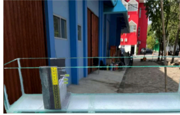
Gambar 3. 15. Model Dudukan Beton Dalam Bak Uji Laboratorium
