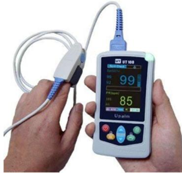
**Gambar 2.3** Alat *pulse oximetry* untuk mengukur saturasi oksigen
