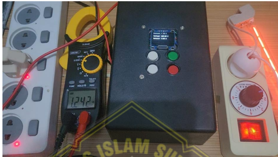
Gambar 4.3 Pengujian Proteksi Alat Rumah Tangga
