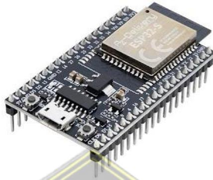
Gambar 2.8 Mikrokontroler ESP32 [20].
