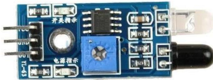
Gambar 2.6 Sensor *Infrared* [18].
