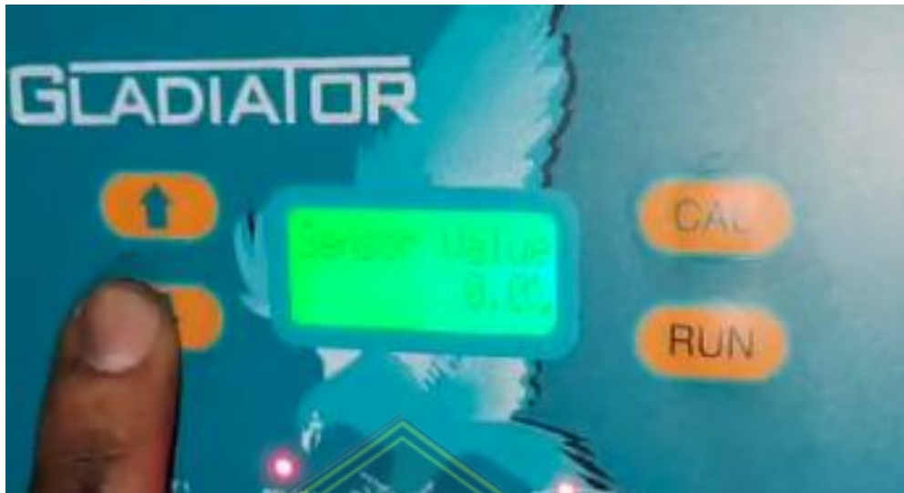
Gambar 4. 4. Tampilan Sensor Value pada unit Kontrol Kondisi Chute Normal
