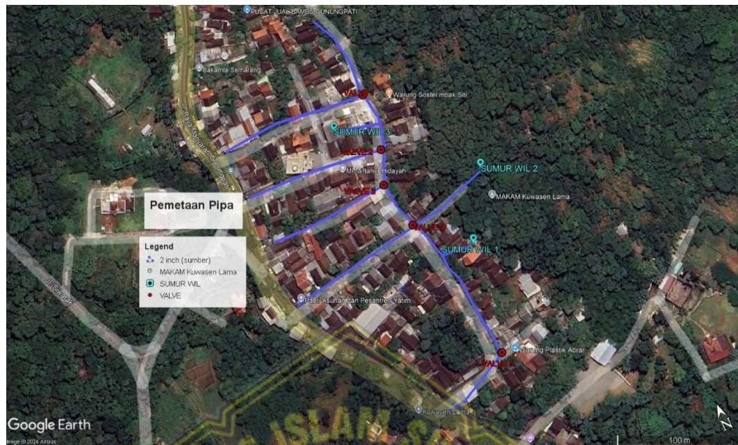
Gambar 3.4 Desain Simulasi Usulan Pertama Dengan Pengaturan Valve
