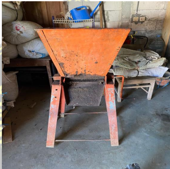
Gambar 2.2 Alat pengupas kulit kopi konvesional
