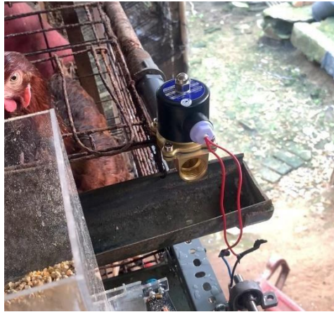
Gambar 5. 5 Pemasangan Solenoid Valve sebagai Pengganti Kran
