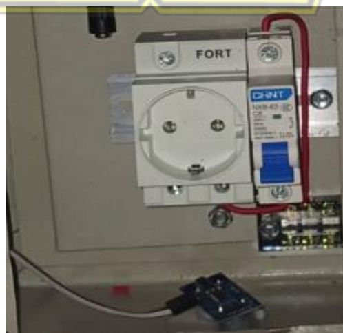
Gambar 5. 7 integrasi komponen proteksi dan distribusi daya
