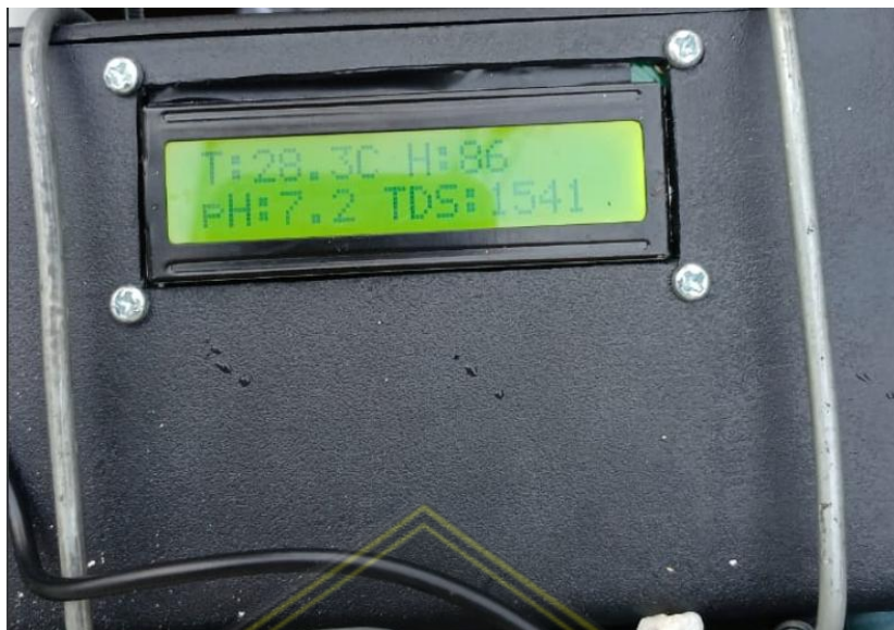
Gambar 5.5 Tampilan layar LCD 16x2 dengan modul I2C
