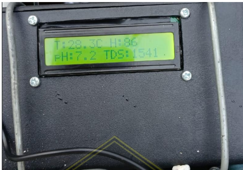
Gambar 5.5 Tampilan layar LCD 16x2 dengan modul I2C
