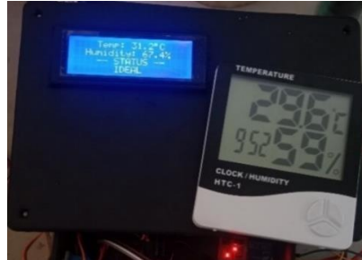
Gambar 5. 6 Pengujian suhu luar dan dalam alat
