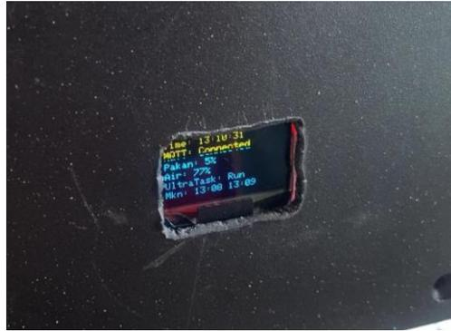
Gambar 5. 4 Tampilan Layar Oled pada Box Control Sistem
