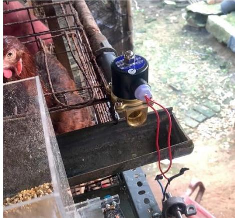
Gambar 5. 5 Pemasangan Solenoid Valve sebagai Pengganti Kran
