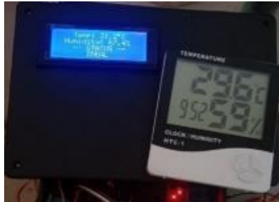
Gambar 5. 6 Pengujian suhu luar dan dalam alat
