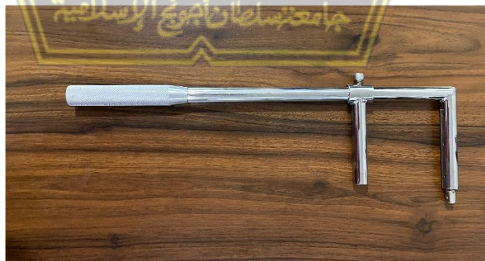
Gambar 4.9 Hasil Akhir Perancangan Universal F-Key
