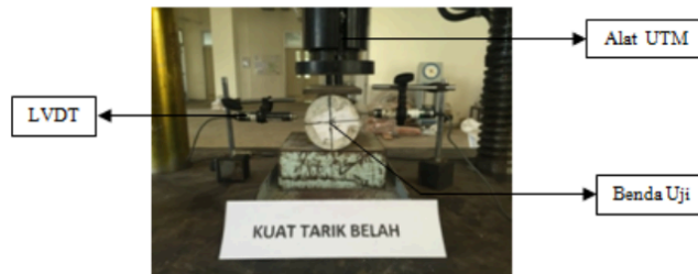
Gambar 3.4 Posisi benda uji pada pengujian kuat tarik belah beton
