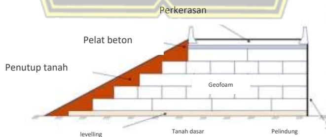
**Gambar 2.4.** Penampang Melintang Timbunan Jalan Dengan Geofom
