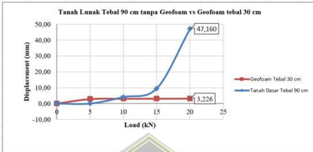
**Gambar 4.26.** *Settlement* Yang Terjadi Pada *Subgrade* Tanah Lunak Tebal 90 cm dengan Timbunan Geofom Tebal 30 cm (*Subgrade* Tanah Lunak 60 cm)
