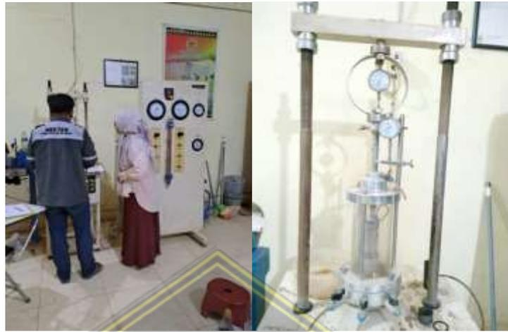
**Gambar 4.5.** Pengujian *Triaxial Test*
