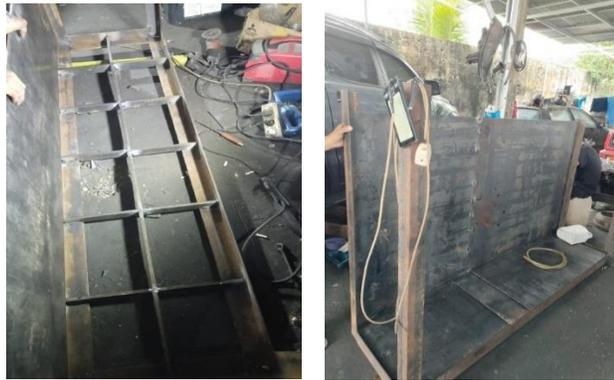
**Gambar 4.3:** Proses Pembuatan Rangka Bak Uji
