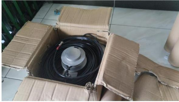
**Gambar 3.14:** *Load Cell* Kapasitas 50 Ton
