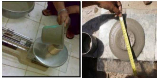
**Gambar 4.22:** Pengujian *Flow*
