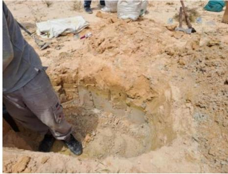
**Gambar 4.5:** Proses Pengambilan Sampel Tanah Terganggu (*Disturbed*)
