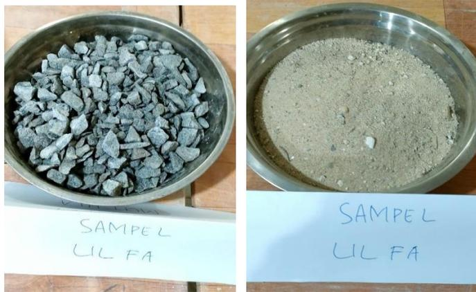
**Gambar 4.28:** Agregat Kasar dan Agregat Halus
