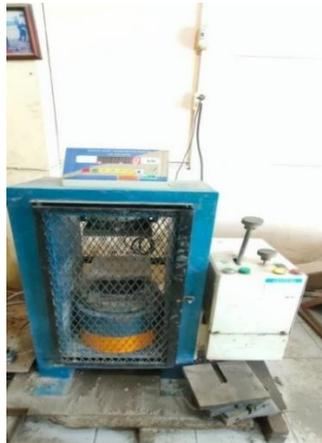
**Gambar 4.30:** Alat Uji Kuat Tekan Beton
