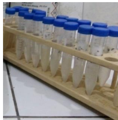
Gambar : Sampel yang sudah di sentrifuge dan ditambahkan metanol hingga 5 ml
