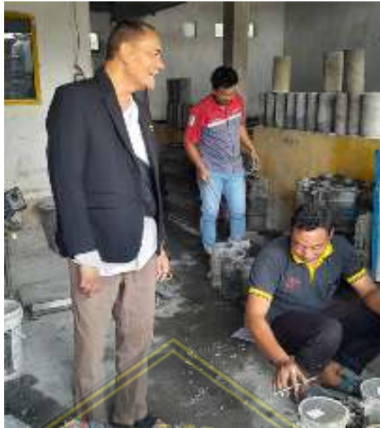
Gambar 4.4 Pembuatan Sampel Uji Kuat Tekan
