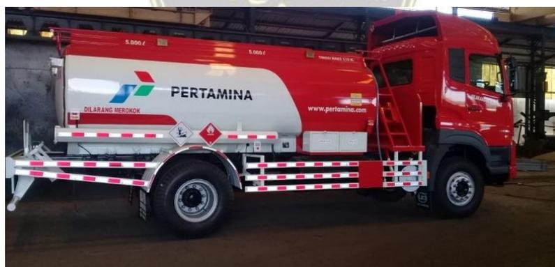
Gambar 4. 2 Mobil tangki kapasitas 8 kl
