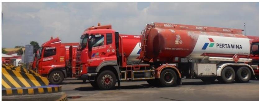
Gambar 4. 3 Mobil tangki kapasitas 16 kl
