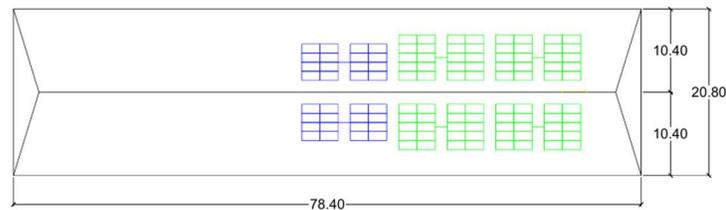
Gambar 4. 6 Penempatan Array PV Gedung 2
