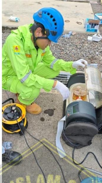
**Gambar 4.6** Pengujian Breakdown Voltage
