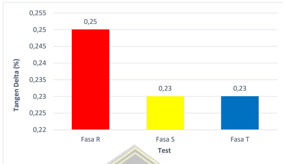
**Gambar 4.5** Grafik Hasil Pengujian Tangen Delta Bushing
