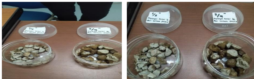
Gambar 3. 2. Agregat dari Limbah Plastik PET
