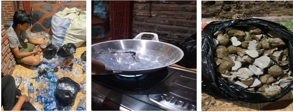
Gambar 4.3. Pembuatan bahan tambah Agregat PET
