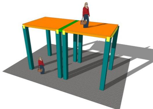
Gambar 2.35 Ilustrasi Dilatasi Kolom
