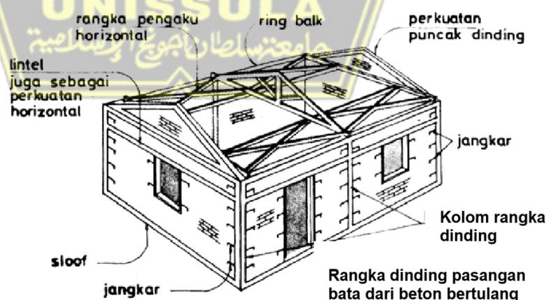
Gambar 2.31 Bangunan Gedung Konstruksi Rangka Sederhana Beton Bertulang Dengan Dinding Pasangan Bertulang
