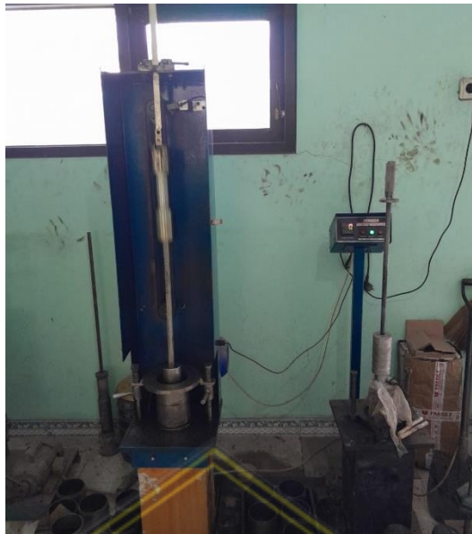
Gambar 3. 5 Penumbukkan sampel menggunakan Aspal Compactor
