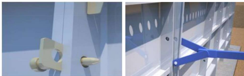
Gambar 2.16 Pelepasan Pin pada Tile dan Pelepasan Panel
